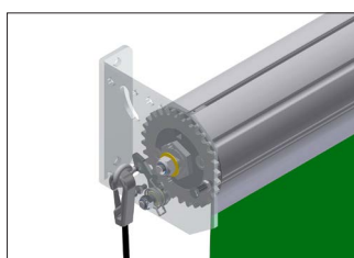
Mecanismul de blocare unic asigură stabilitate în condiții de vânt puternic
